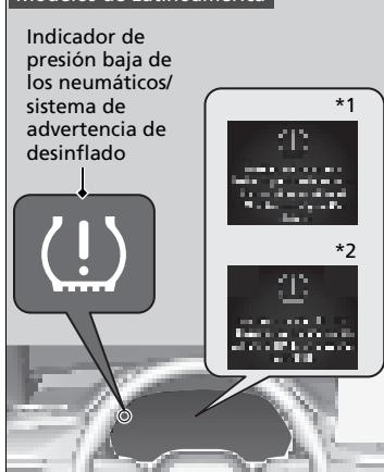
Esto provocará que se encienda el indicador de presión baja de los neumáticos/sistema de advertencia de desinflado y que aparezca un mensaje en la interfaz de información del conductor.
