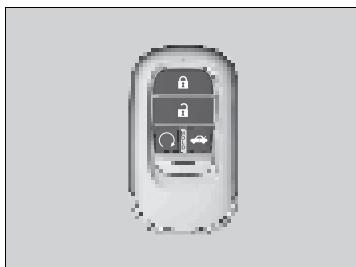
Utilice las llaves para encender y apagar el sistema, bloquear y desbloquear todas las puertas y la tapa del depósito de combustible, y para abrir el maletero.
