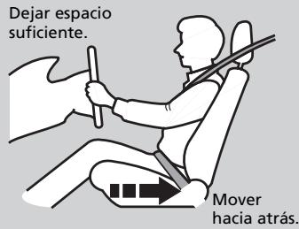
Ajuste el asiento del conductor lo más atrás posible, en una posición que le permita mantener el control total del vehículo. Deberá poder sentarse con la espalda recta bien apoyada en el respaldo y pisar adecuadamente los pedales, sin tener que inclinarse hacia delante, y sujetar el volante con comodidad. El asiento del acompañante deberá ajustarse de forma similar, para que permanezca lo más alejado posible del airbag frontal del salpicadero.
