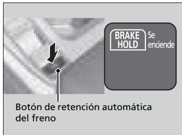
Abróchese el cinturón de seguridad correctamente y, a continuación, encienda el sistema de alimentación. Pulse el botón de retención automática del freno.
