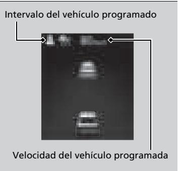
Cuando el ACC con seguimiento de baja velocidad comienza a funcionar, el icono de vehículo, las barras de intervalo y la velocidad programada aparecen en el medidor.
