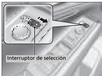
Si está activada esta función, el retrovisor exterior de la puerta del acompañante se inclina automáticamente hacia abajo cuando se coloca la transmisión en **R**; esto mejora la visibilidad en el lado del acompañante con la marcha atrás. El retrovisor regresa automáticamente a su posición original cuando se quita la transmisión de **R**.
