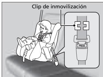
**Cinturón de seguridad de tres puntos sin retractor de bloqueo**
